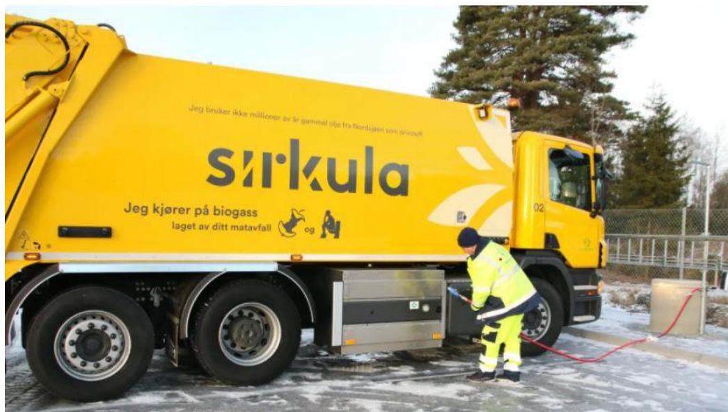
Renovasjonsbil på biogass
